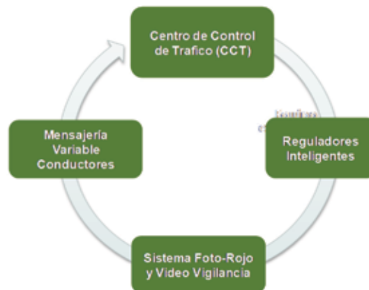
Figura 6-105. Componentes del Centro de Control y Gestión del Tráfico
